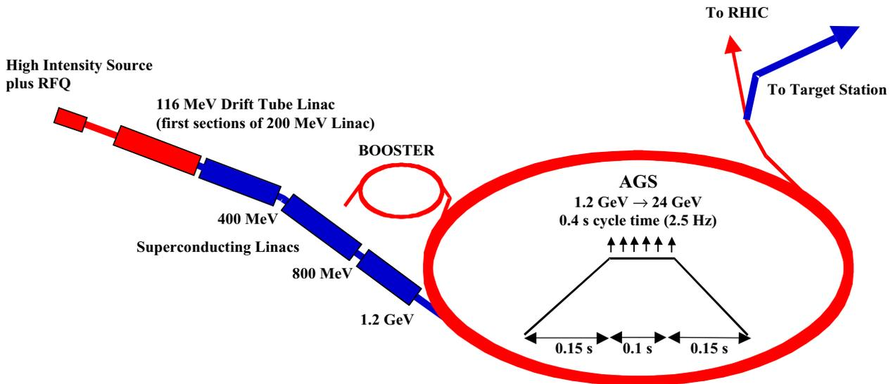
Figure 1. AGS Proton Driver Layout
